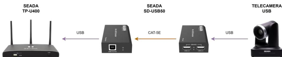
1. Collegare il connettore A del cavo USB 2.0 A-B (in dotazione con kit extender) su una delle porte USB 3.0 posteriori del sistema di condivisione; collegare il connettore B alla porta *USB (TO PC)* del trasmettitore dell'extender USB.
